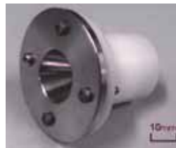
上段左s スペースチャンバー...宇宙真空環境を模擬できる装置。製作したエンジンの噴射実験を行いそれらの推進性能や耐久性を測る。上段中s パルスプラズマ型エンジンの噴射の様子。上段右s 製作したパルスプラズマエンジン。下段左s 人工衛星試作機。下段右s 人工衛星完成予想図
